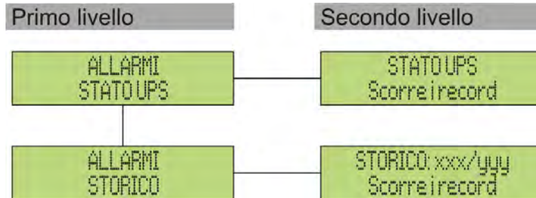
Figura 13 – Struttura menu allarmi
