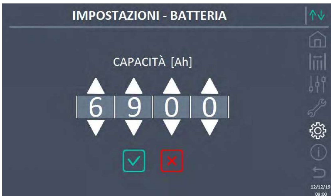
Figura 25 – Impostazione capacità batteria centralizzata
